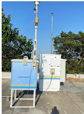
Imagen: Shelters de Monitoreo de Material Particulado y Shelter de Monitoreo de Gases O 3 . (Ozono)
